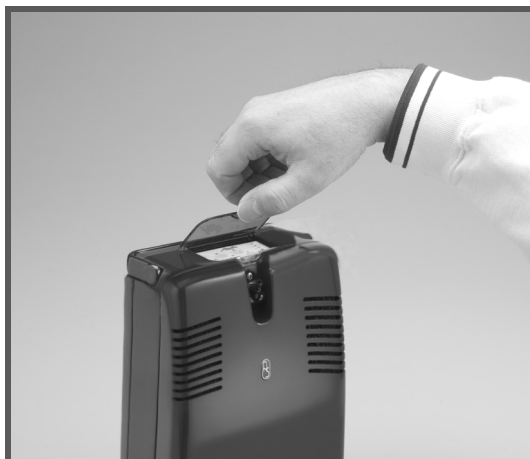
Figur 16: Løft støvdækslet over tastaturet
