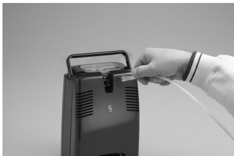
Figur 10: Tilslutning af iltbrille til iltudtaget på FreeStyle 5
