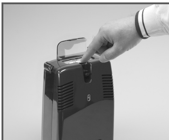
Εικόνα 17: Πάτημα κουμπιού επιλογής ροής
